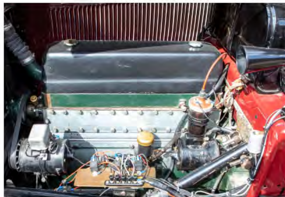
Elektrisk självstart från Delco-Rémy och kylning via vattenpump. Det var saker som gärna framhölls i reklamen för denna modell.
