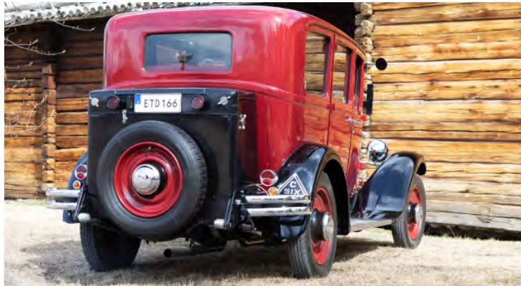
Nu är den räddad och visst känns linjerna igen. Bagageutrymmet fungerar även som reservhjulshållare. Notera de diskreta blinkerstämporna och det rejält utdragna avgasröret.
