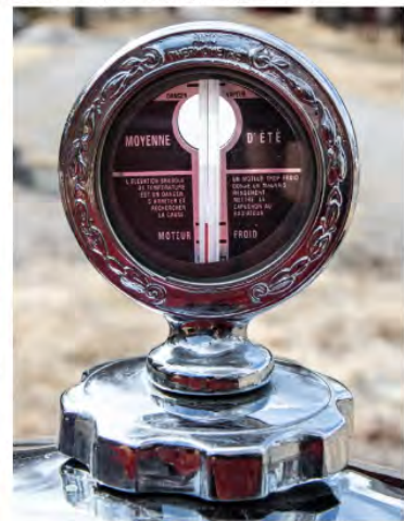
Bilens temperaturmätare är en vackert skulpterad termometer på kylaren med förklarande text. När kvicksilvret går högst upp när den markeringen Danger Vapeur (Fara Ånga).
