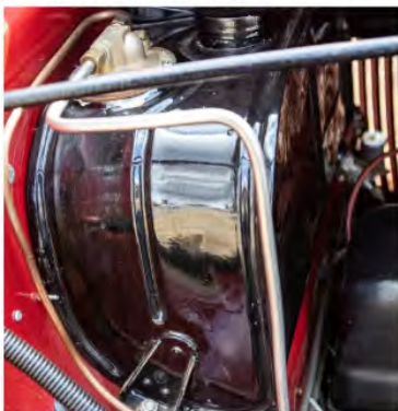
Det avancerade bränslesystemet låter motorns vakuüm dra fram bensin från den bakre huvudtanken till den lilla hjälptanken på torpedväggen.
