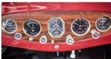
Bensinmätare, oljetryck, samt klocka och amperemätare flankerar hastighetsmätaren vars stil återkom i efterföljande modeller.
