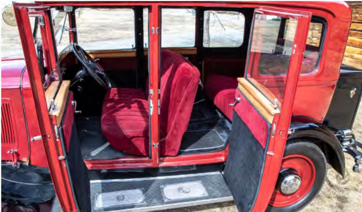
Passagerarutrymmet är snarlikt det på den mindre modellen C4 och rymmer fem passagerare. Både C4 och C6 fanns som modellen Familiale med tre sätesrader.
