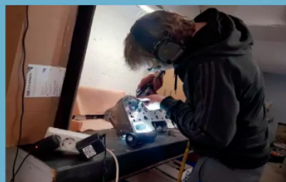
Johan tillbringade så mycket tid med att portmatcha och räta ut kanalerna på både insug och avgassidan att han stod upp till knäna i aluminiumspån.
