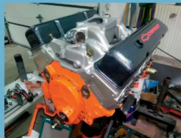
Johan tillbringade så mycket tid med att portmatcha och räta ut kanalerna på både insug och avgassidan att han stod upp till knäna i aluminiumspån.
