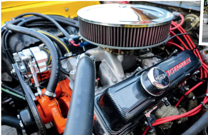
Toppar och insug i aluminium och lindade avgasrör samt höga, mörka kolfilterkåpor gör besökaren en smula misstänksam över angiven motorstyrka när byggherrens kommentar är "lite uppfräschad".
